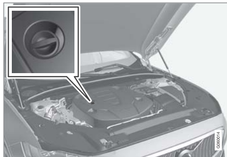
ท่อเติมน้ำมัน 13
