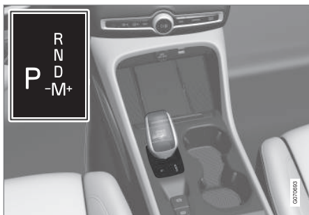
Přehled - malá řadič páka a schéma řazení na displeji řidiče.
