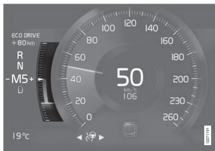
Indikace Eco na 8" displeji řidiče.
