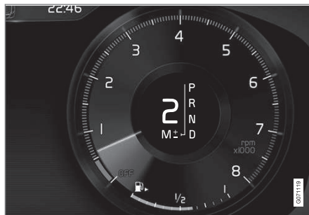
Přehled - schéma řazení na displeji řidiče u velké řadicí páky.
