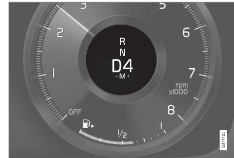
Displej řidiče při řazení pomocí pádel na volantu, malá řadicí páka.
