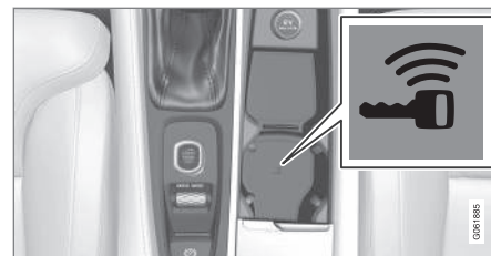
Umístění záložní čtečky v tunelové konzole.
