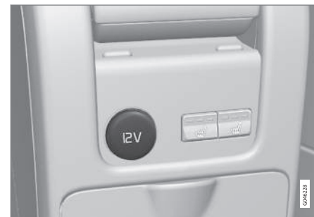
12V-aansluiting in middenconsole, achterin.
