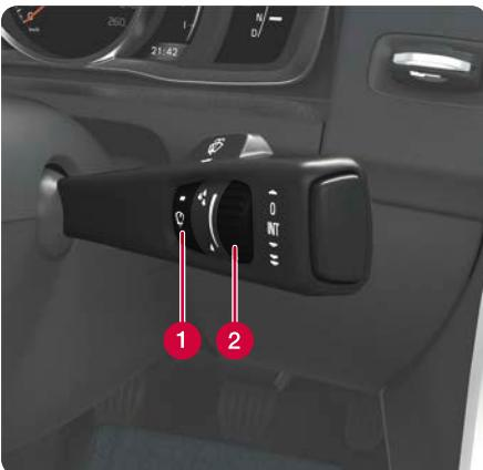
Hebel nach unten drücken, um die Scheibenwischer einzuschalten, und nach oben, um einzelne Wischbewegungen durchzuführen.
