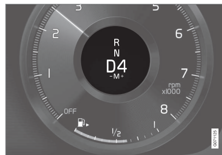
Displej řidiče při řazení pomocí pádel na volantu, malá řadicí páka.
