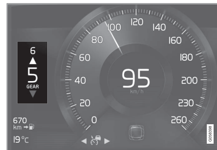
Indikátor řazení převodových stupňů na 8" displeji řidiče.
