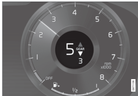
Indikátor řazení převodových stupňů na 12" displeji řidiče*.
