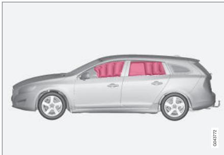
La cortina inflable IC (Inflatable Curtain) forma parte del sistema SIPS (p. 40) y el sistema de airbags (p. 35). Va montado a lo largo de ambos lados del techo interior y contribuye a proteger al conductor y a los pasajeros situados en los asientos exteriores del vehículo. En caso de una colisión de suficiente intensidad, los sensores reaccionan y el airbag de techo lateral se infla.
