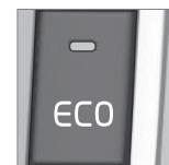
La función ECO desactivada se indica apagándose el símbolo **ECO** en el cuadro de instrumentos y la luz del botón ECO. La función permanece desconectada hasta que vuelve a conectarse con el botón ECO.
