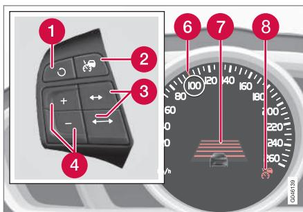
Programador de velocidad adaptativo **sin** limitador de velocidad<sup>9</sup>.
