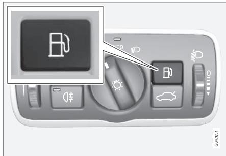
Abra la tapa del depósito con el botón del panel de las luces. La tapa se abre al soltar el botón.
