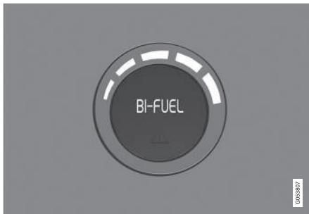
Pulse el interruptor para alternar entre operación por gas y gasolina.
