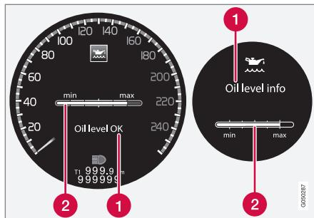
Se muestra un mensaje y un gráfico en la pantalla. La pantalla de la izquierda muestra el cuadro de instrumentos digital y la de la lado derecho el cuadro de instrumentos analógico.
