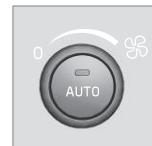
Gire el mando para aumentar o reducir la velocidad del ventilador. Si se selecciona **AUTO**, la velocidad del ventilador se regulará de forma automática (p. 147) y se desconectará la velocidad ajustada manualmente.
