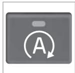
La función Start/Stop se activa automáticamente al arrancar el motor con la llave. El sistema avisa al conductor encendiéndole el símbolo de la función en el cuadro de instrumentos y encendiéndole la luz del botón de conexión y desconexión.
