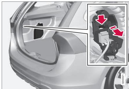
Las bombillas de las luces de marcha atrás, las luces antiniebla y los intermitentes traseros se cambian dentro del compartimento de carga.
