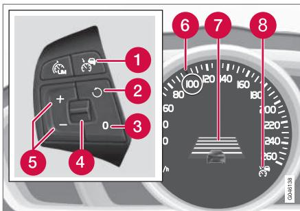
Programador de velocidad adaptativo **con** limitador de velocidad<sup>9</sup>.
