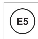
La E5 es una gasolina con un máximo de oxígeno del 2,7% y un nivel máximo de etanol del 5% de volumen.
