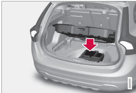
Debajo del piso del compartimento de carga se guardan la anilla de remolque, el gato\* y la llave para los tornillos de rueda\* del automóvil. Se incluye también aquí espacio para el manguito de los tornillos de seguridad de la rueda y herramientas para los capuchones de plástico de los tornillos de rueda.
