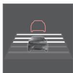
El conductor puede seleccionar diferentes intervalos de tiempo que se indican en el cuadro de instrumentos en forma de 1 a 5 rayas horizontales. Cuanto más rayas, mayor es el intervalo de tiempo. Una raya equivale a una distancia de seguridad de aproximadamente 1 segundo, 5 rayas a 3 segundos.
