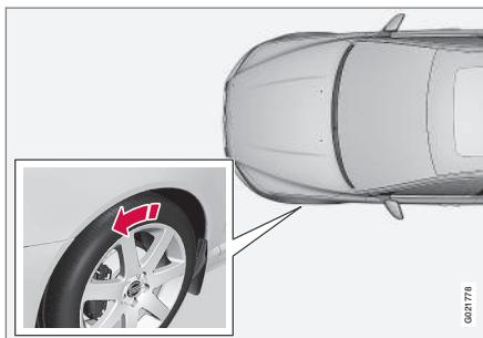
La flecha muestra el sentido de rotación del neumático.
