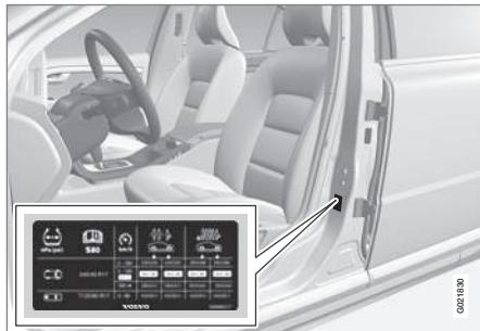
La placa de presión de neumáticos situada en el montante de la puerta del lado del conductor (entre la puerta delantera y la trasera) especifica la presión que deben tener los neumáticos en diferentes condiciones de carga y velocidad. Estos datos se indican también en la tabla de presiones de neumáticos, véase Neumáticos - presiones de inflado aprobadas (p. 473).
