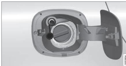
1. Abra la portezuela del depósito y retire la tapa protectora del racor de gas.
