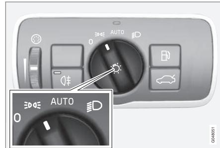
Mando de las luces en la posición de luces de posición.
