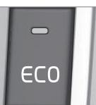
Si está activada la función ECO, el motor puede apagarse automáticamente antes de detenerse el vehículo.
