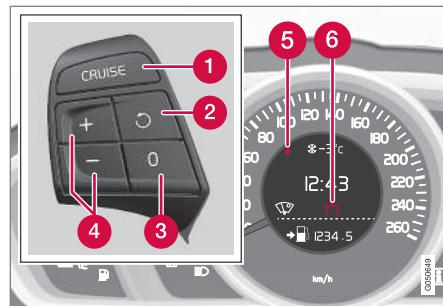
Teclado de volante y cuadro de instrumentos en vehículo **sin** limitador de velocidad<sup>2</sup>.
