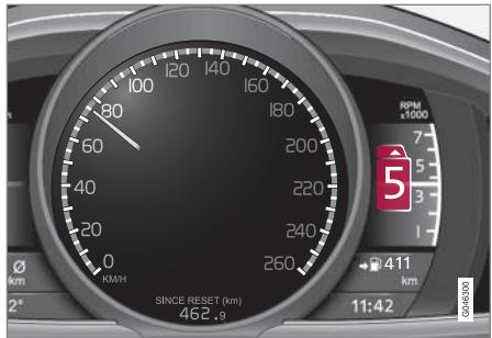
Cuatro de instrumentos "Digital" con indicador de cambio de marcha.
