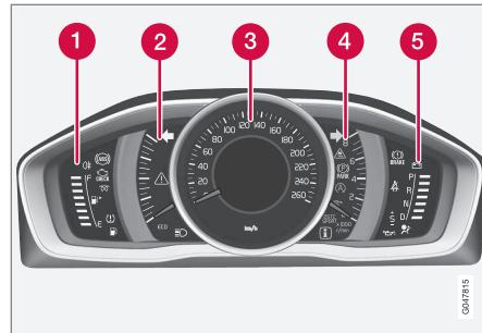
**1** Indicador de combustible. Cuando la indicación se reduce a una sola señal blanca<sup>1</sup>, se enciende el símbolo de control de bajo nivel en el depósito de combustible. Véase también Centro de Información Electrónico (p. 126) y Llenado de combustible (p. 332).
