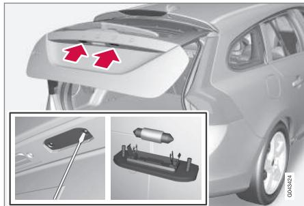
1. Suelte los tornillos con un destornillador.
