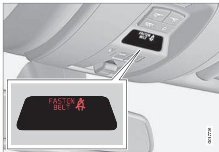
El aviso acústico depende de la velocidad y, en algunos casos, del tiempo. La señal luminosa se puede ver en la consola del techo y en el cuadro de instrumentos (p. 70).
