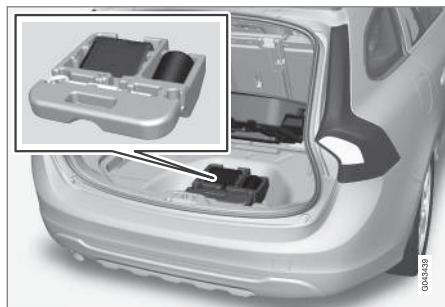
El kit de reparación de neumáticos está debajo del piso del maletero.
