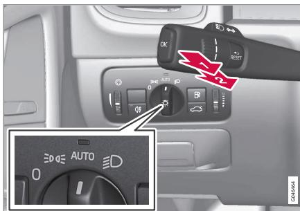
Palanca del volante y mando de las luces.
