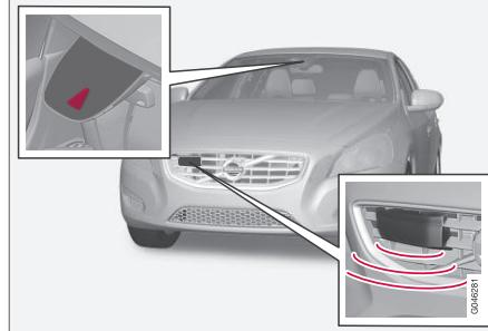
Sensor de cámara y de radar<sup>21</sup>.
