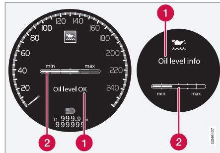
Se muestra un mensaje y un gráfico en la pantalla. La pantalla de la izquierda muestra el cuadro de instrumentos digital y la de lado derecho el cuadro de instrumentos analógico.
