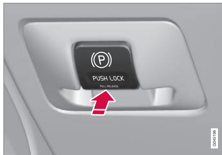
Stāvbremzes vadība - ieslēgšana.
