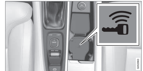
Varmistuskujan sijainti tunnelikonsolissa.
