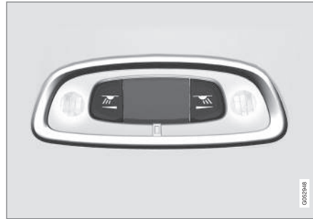
Toisen 17 ja kolmannen istuinvirvin* yläpuolella olevat lukuvalot.
