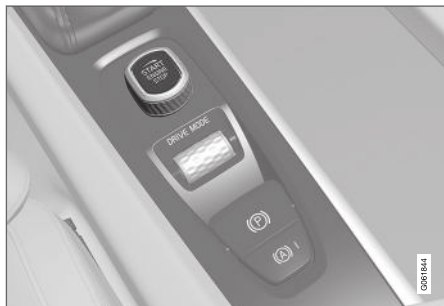
Disco de arranque na consola de túnel.
