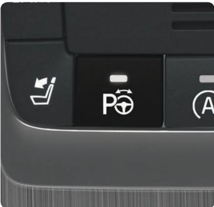
1 Zum Aktivieren der aktiven Einparkhilfe PAP die Taste drücken. Nicht schneller als 30 km/h (20 mph) fahren.
