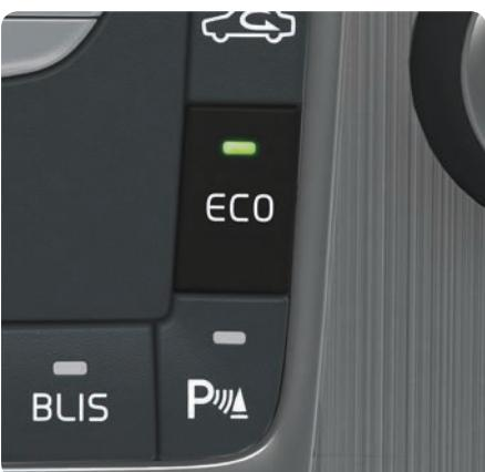
Durch Drücken von **ECO** aktivieren Sie ein Fahrprogramm, das vorrangig auf einen möglichst niedrigen Kraftstoffverbrauch abgestimmt ist und folgende Änderungen beinhaltet:
