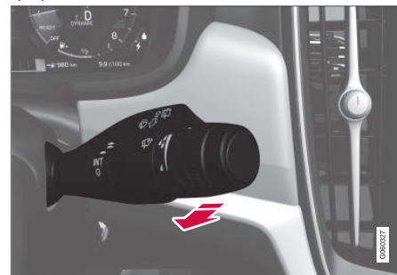
Функція омивання скла, правий підкермовий вимикач.
