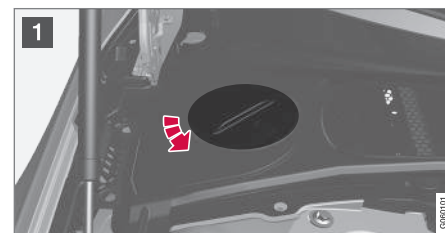
Розширювальний бачок охолоджувальної рідини, авто з лівостороннім кермом.
