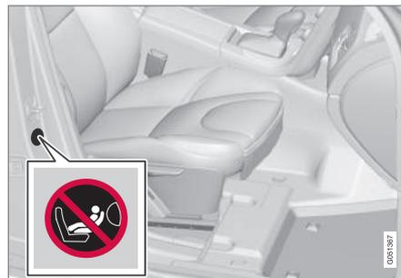
Autocolante no pilar da porta do lado do passageiro. O autocollante fica visível quando se abre a porta do passageiro.
