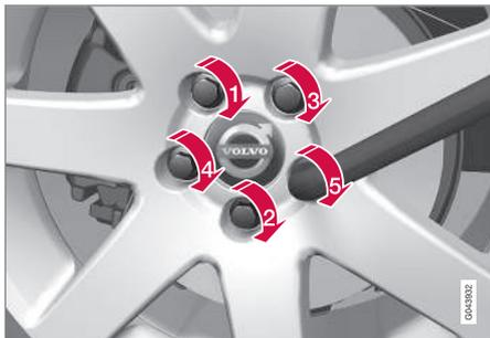
4. Aperte os parafusos da roda em cruz. É importante que os parafusos da roda sejam correctamente apertados. Aperte a 140 Nm. Verifique os binários com uma chave dinamométrica.
