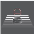
No instrumento combinado podem ser seleccionados e exibidos diferentes durações de passagem para o veículo da frente através de 1-5 linhas horizontais - quanto maior o número de linhas maior é a distancia para o veículo da frente. Uma linha corresponde a cerca de 1 segundo em relação ao veículo da frente, 5 linhas a cerca de 3 segundos.
