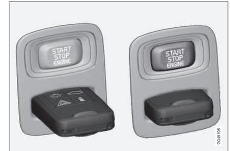
Interruptor de ignição com o comando à distância ejetado/insertado.
