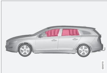
A cortina de colisão (Inflatable Curtain) faz parte do sistema SIPS (pág. 40) e do sistema de airbags (pág. 35). Está montado ao longo do forro do teto de ambos os lados e ajuda a proteger o condutor e os passageiros que vão nos lugares laterais do veículo. Perante uma colisão suficientemente forte, os sensores reagem e a cortina de colisão é insuflada.
