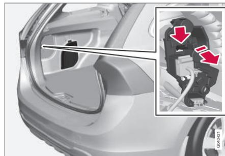
As lâmpadas de marcha-atrás, luz de nevoeiro e dos indicadores de mudança de direção na luz traseira são substituídas a partir do interior do compartimento da carga.
