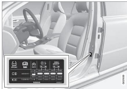
O autocolante da pressão dos pneus no pilar da porta do lado do condutor (entre a porta dianteira e traseira) indica as pressões correctas dos pneus para diferentes condições de carga e velocidades. Estas pressões também se encontram indicadas na tabela da pressão dos pneus, ver Pneus - pressão de pneus aprovada (pág. 472).
