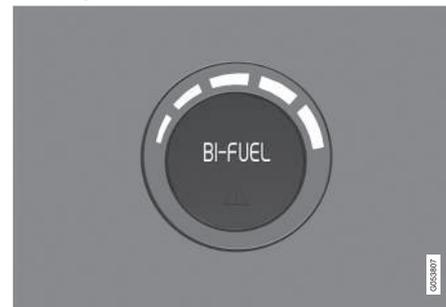
Pressione no interruptor para alternar entre funcionamento a gás e a gasolina.
