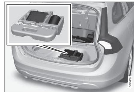
O kit de reparação de emergência de pneus furados encontra-se sob o chão do compartimento da carga.
