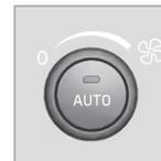
Rode o botão para aumentar ou diminuir a velocidade do ventilador. Se for seleccionado **AUTO**, a velocidade do ventilador é regulada automaticamente (pág. 147) - a velocidade anteriormente ajustada é
