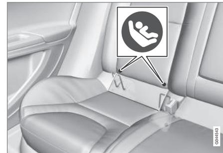
Os pontos de fixação para o sistema de fixação ISOFIX encontram-se dissimulados atrás da parte inferior das costas do banco traseiro, nos lugares exteriores.
