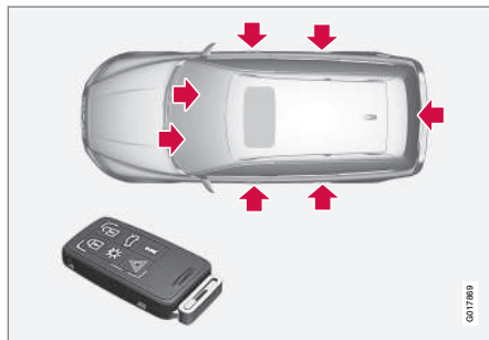
Puntos de cierre del mando a distancia con la llave extraíble.
