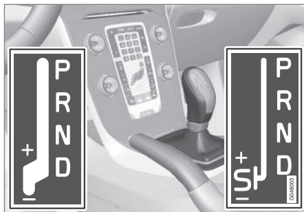
D: Automātisko pārnesumu pozīcijas. +/-: Manuālo pārnesumu pozīcijas. S: Sporta režīms*.
