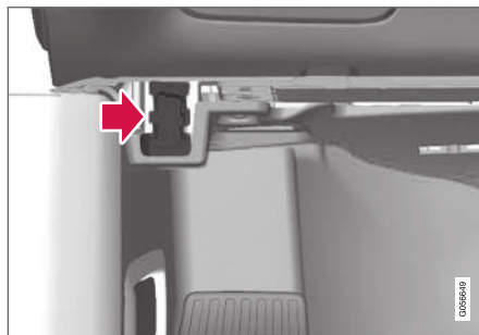
Diagnoosiusulosotto (On-board Diagnostic -liitäntä, OBDII) kojelaudan alla kuljettajan puolella.
