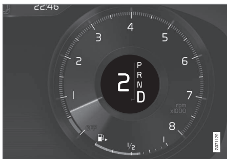
Mostrador do condutor nas mudanças com as alavancas do volante, alavanca das mudanças grande.
