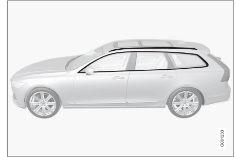
Elementos que devem ser lavados com agente de limpeza com um valor de pH entre 3,5 e 11,5.
