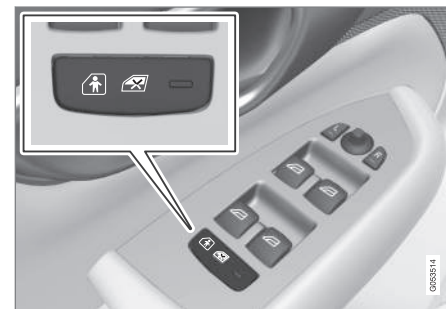
Botão para ativação e desativação elétrica.
