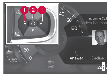
Exemplo de mensagem no mostrador do condutor 5 e unidade de botões do lado direito do volante.
