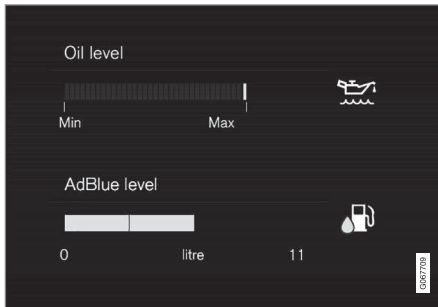
Gráfico do nível AdBlue no mostrador central.
