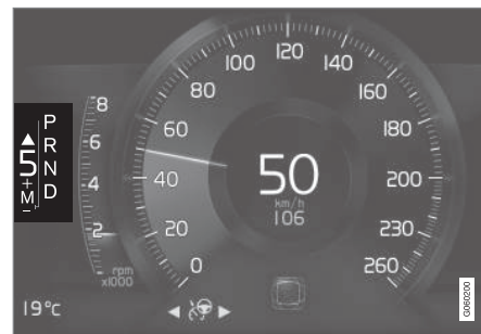
Indicador de mudanças no mostrador do condutor de 8 polegadas para a alavanca das mudanças grande.
