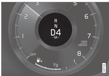
Mostrador do condutor nas mudanças com as alavancas do volante, alavanca das mudanças pequena.
