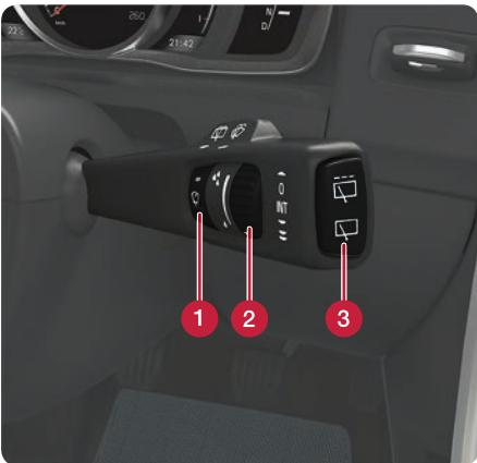
**Jak mám spustit stěrače čelního skla a deštový senzor\***
