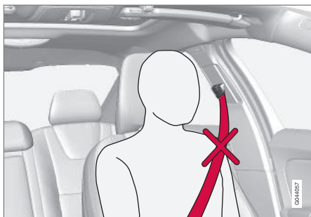
Réglage inadéquat de la hauteur
