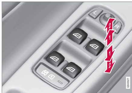
Fonctionnement des vitres électriques
