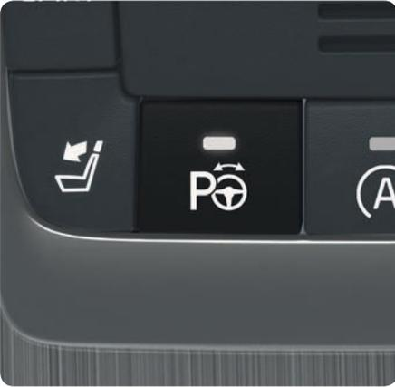
PAP kontrolliert den verfügbaren Freiraum und steuert das Fahrzeug entsprechend. Die Aufgabe des Fahrers besteht in der Wahl des Gangs, dem Regeln der Geschwindigkeit und dem Bremsen/Anhalten.
