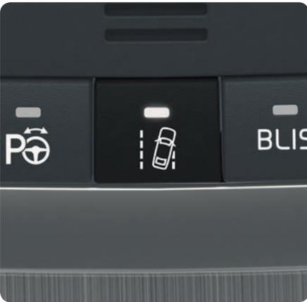
Wenn das Fahrzeug im Begriff ist, einen Seitenstreifen zu überfahren, wird der LKA aktiv eingreifen und durch ein schwaches Andrehen des Lenkrads auf die Fahrbahn zurücksteuern. Wenn das Fahrzeug einen Seitenstreifen überfährt, wird der LKA eine Warnung mit pulsierenden Vibrationen im Lenkrad ausgeben.
