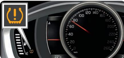
Eine Kalibrierung muss nach jedem Reifenwechsel und nach jeder Änderung des Reifendrucks durchgeführt werden. Wenn die Leuchte (⚠) aufleuchtet, muss das System kalibriert werden. Gehen Sie dazu wie folgt vor:
