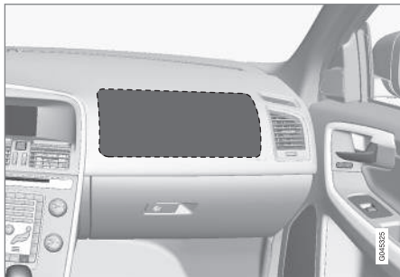
Plassering kollisjonspute på passasjersiden i bil med venstreratt.
