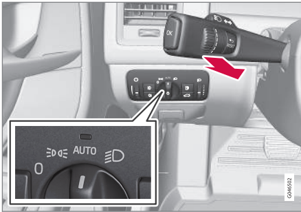
Rattspake og lysbryter i posisjon AUTO .
