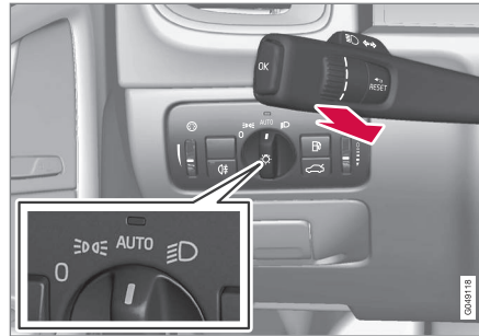
Przełącznik przy kierownicy i pokręćło przełącznika świateł w pozycji AUTO .
