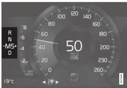
Indicador de mudanças no mostrador do condutor de 8 polegadas para a alavanca das mudanças pequena.
