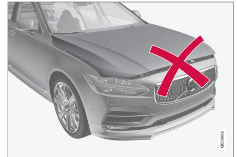
Capot não completamente fechado.
