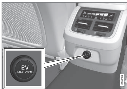
Tomada eléctrica 12 V na consola de túnel, banco traseiro.
