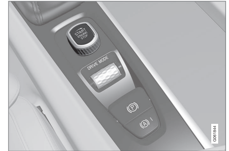
Disco de arranque na consola de túnel.
