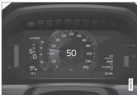
Mostrador do condutor 8 polegadas.
