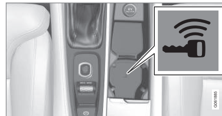
Localização do leitor de recurso na consola de túnel.
