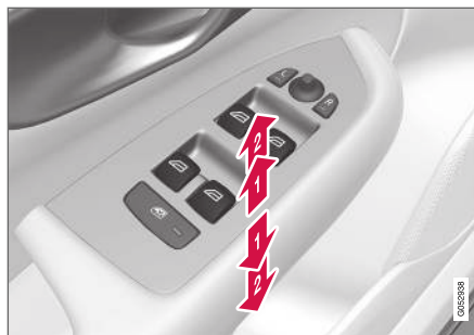
Fonctionnement des vitres électriques.
