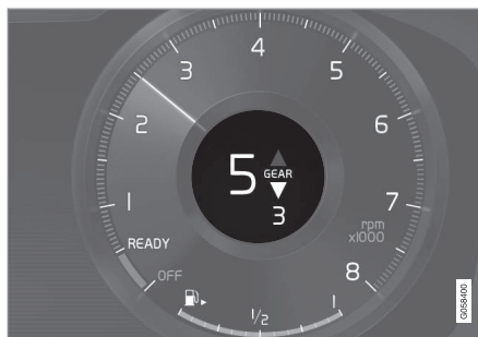
Schakelindicator op 12 inch bestuursdisplay.
