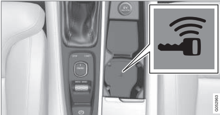
Positie back-uplezer in de tunnelconsole.
