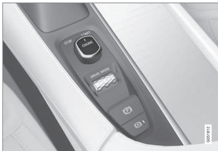
De startknop op de tunnelconsole.
