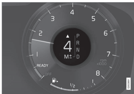
Schakelindicator op 12 inch bestuursdisplay.
