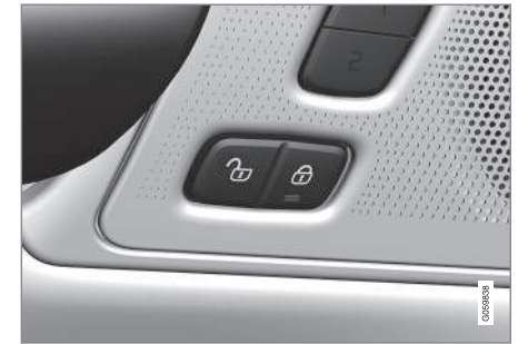
Knop voor vergrendeling/ontgrendeling op voorportier met led.
