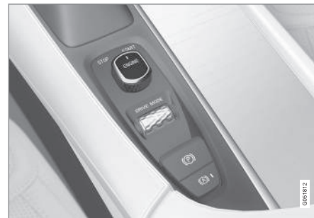
De startknop op de tunnelconsole.
