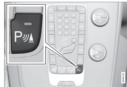
Til-/fra for sensorerne til Parkeringshjælp og CTA 30 .
