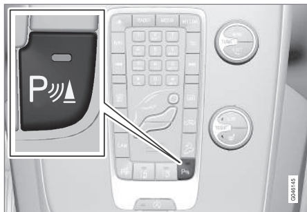
Til-/fra for sensorerne til Parkeringshjælp og CTA.
