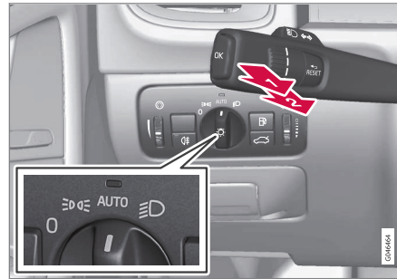
Stuurhendel en verlichtingsdraaiknop.
