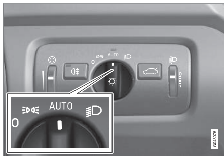
Bouton du commutateur d'éclairage en position AUTO .
