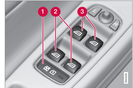
Säädinpaneeli kuljettajan ovessa.
