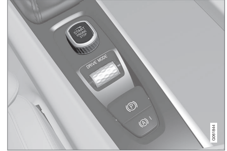
Tünel konsolundaki çalıştırma düğmesi.
