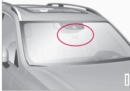
Radar ünitesi konumu
