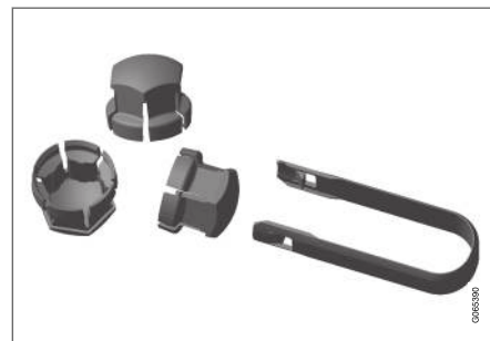
Outil de dépose des caches de plastique sur les boulons de roue.
