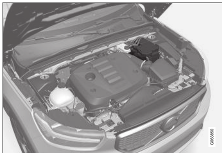
La batterie de démarrage se trouve dans le compartiment moteur.
