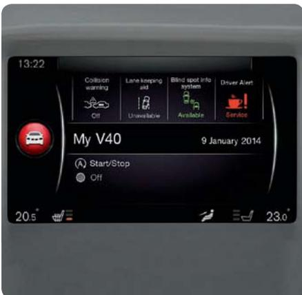
Dans le système MY CAR, de nombreuses fonctions de la voiture sont traitées, comme par exemple paramètres de l'horloge, des rétroviseurs extérieurs et des serrures.
