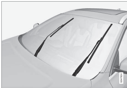
Az ablaktörlő lapátok a szervizállásban.
