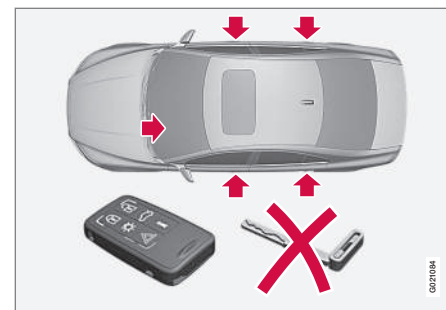
Aktív záruk kulcsszár nélküli távvezérlős kulccsal és a szervíz üzemmód aktív állapotában.
