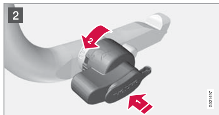
2 推入鎖定輪 1 並逆時針轉動 2 直到聽到一卡入聲。
