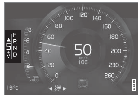
Girskiftindikator for stor girspak på 8-tommers førerdisplay.
