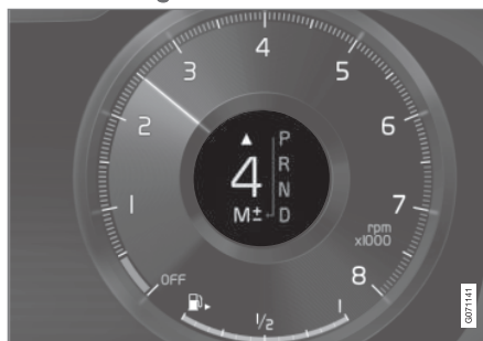
Girskiftindikator for stor girspak på 12-tommers førerdisplay*.
