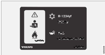
2 Dekal A/C-systemet för bilar med köldmediet R1234yf.
