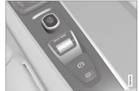
Startvredet i tunnelkonsolen.
