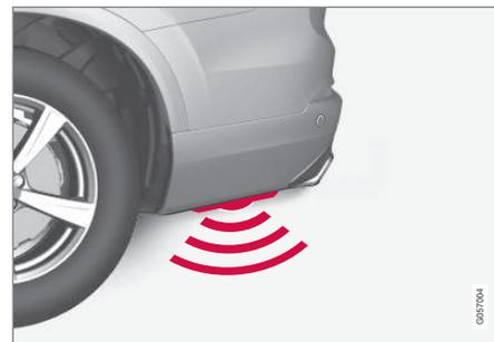
Wenn das Fahrzeug mit dem Zubehör Unterfahrschutz/ Diffuser\* ausgestattet ist, befindet sich der Sensor links außen am Stoßfänger.
