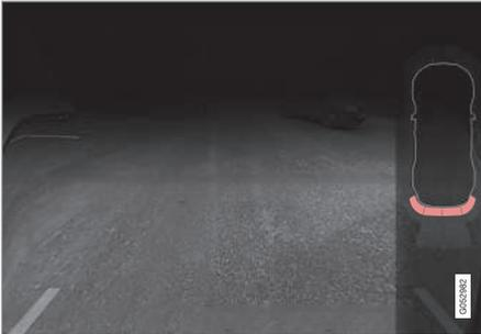
Auf dem Bildschirm können eingefärbte Sensorfeldern am Fahrzeugsymbol rechts angezeigt werden.
