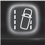
Ist dies nicht der Fall, erscheint im Fahrerdisplay ein Symbol und die Mitteilung **Spurassistent Lenken**. Damit wird der Fahrer aufgefordert, das Fahrzeug aktiv zu lenken.
