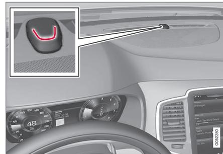
Die Verriegelungs- und Alarmanzeige auf dem Armaturenbrett zeigt den Status des Verriegelungssystems an.
