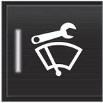
Tippen Sie auf die Taste **Wartungsposition Wischer**. Bei aktivierter Wartungsstellung leuchtet die Anzeigeleuchte der Taste. Bei Aktivierung der Funktion werden die Scheibenwischer gerade nach
