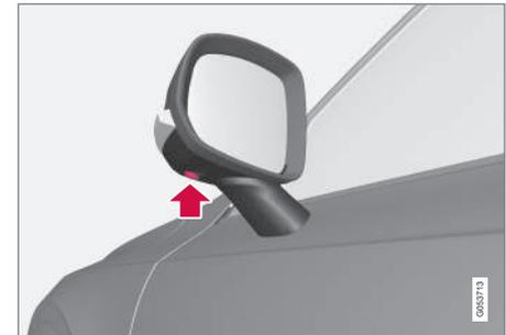
Die Seitenkameras befinden sich in den Seitenspiegeln.
