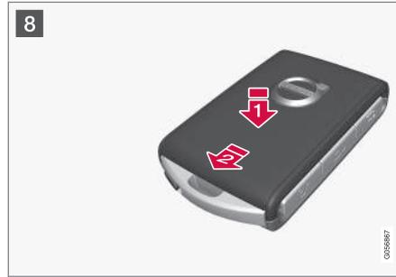
**8** Transponderschlüssel umdrehen und die Abdeckung der Vorderseite wieder anbringen, indem sie nach unten gedrückt wird, bis ein Klickgeräusch zu hören ist.
