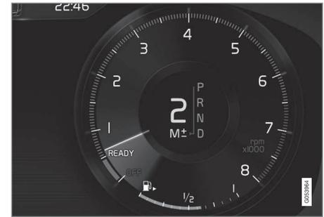
Manuelle Schaltstellung im Fahrerdisplay<sup>2</sup>
