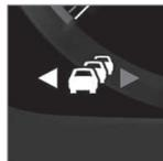
Falls Pilot Assist ausgewählt ist, erkennen Sie die Verfügbarkeit der Funktion an der Farbe des Symbols (WEISS = verfügbar).
