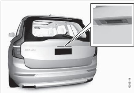
Die gummierte Druckplatte am Griff der Heckklappe dient ausschließlich der Entriegelung.
