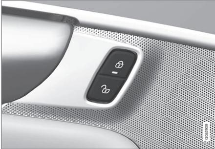
Verriegelungstasten mit Anzeigelampe an der Vordertür.
