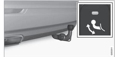
3. Führen Sie die Anhängerkupplung in ihre Endstellung und lassen Sie sie einrasten – die Anzeileuchte leuchtet konstant orange.
