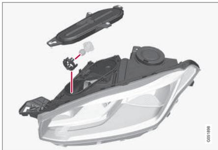
1. Die Sperrbügel zusammendrücken und die Lampenfassung gerade herausziehen.
