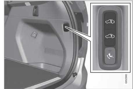
Mit den Tasten im Kofferraum können Sie die Höhe des Hecks einstellen, um das Beladen oder das An- oder Abkuppeln eines Anhängers zu erleichtern. Siehe auch den Abschnitt „Beladung“.
