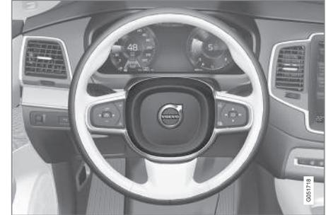
Das Signalhorn befindet sich in der Mitte des Lenkrads.
