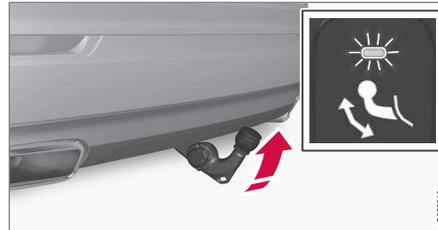
2. Drücken Sie den Schalter und lassen Sie ihn wieder los. Ein zu langes Drücken des Schalters kann dazu führen, dass der Ausklappvorgang nicht gestartet wird.
