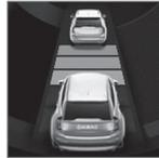
Es können verschiedene Zeitabstände zum vorausfahrenden Fahrzeug eingestellt und auf dem Fahrerdisplay als 1-5 horizontale Linien angezeigt werden – je mehr Linien, desto größer der Zeitabstand. Eine
