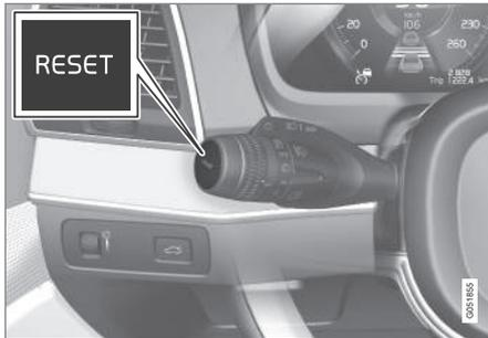
Halten Sie zum Zurücksetzen des Tageskilometerzählers TM die **RESET**-Taste am linken Lenkradhebel gedrückt.
