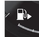
Auf dem Fahrerdisplay zeigt ein Pfeil neben dem Tanksäulensymbol an, auf welcher Fahrzeugseite sich die Tankklappe befindet.
