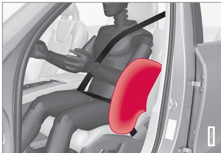
Die Seitenairbags sind im Außenrahmen der Rückenlehnen montiert und helfen, Fahrer und Beifahrer in den Vordersitzen zu schützen.
