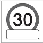
Ein Symbol für ein Zusatzschild in Form eines leeren Rahmens unter dem Geschwindigkeitsymbol im Fahrerdisplay bedeutet, dass das RSI ein Zusatzschild mit zusätzlichen Informationen zur aktuellen
