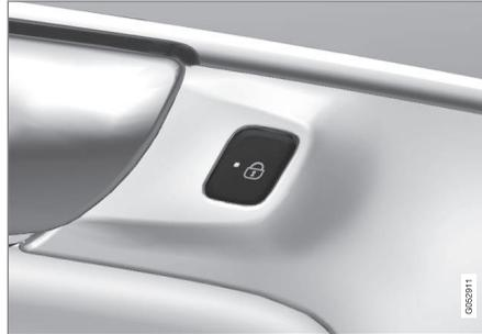
Verriegelungstaste mit Anzeigelampe an der Fondtür.
