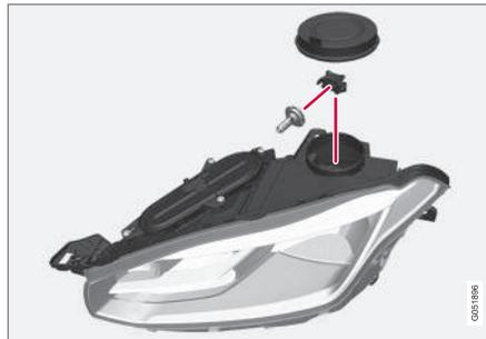
1. Die runde Gummidichtung vom Scheinwerfer lösen.
