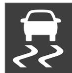
Beim Bremsen kann der Eingriff des ESC-Systems als ein pulsierendes Geräusch erlebt werden. Bei Gaszufuhr kann das Fahrzeug langsamer als erwartet beschleunigen.
