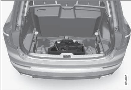
Im Schaumblock unter dem Laderaumboden befinden sich die Abschleppöse, der Reifenabdichtungsring, ein Ausbauwerkzeug für die Kunststoffkappen der Radschrauben, ein Wagenheber\* und ein Radschlüssel\*. Hier gibt es auch Platz für die Hülle des abschließbaren Radschraubenschlüssels.
