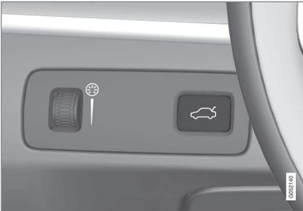
Die Heckklappe wird über eine Taste im Schalterfeld Beleuchtung oder auf dem Transponderschlüssel (
