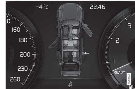
Grafik im Fahrerdisplay mit verschiedenen Arten von Warnungen. Die Warnfarbe an Türen und Heckklappe ist von der Geschwindigkeit des Fahrzeugs abhängig.
