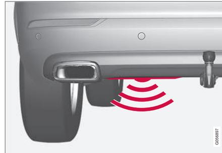
Der Sensor befindet sich etwas links von der Mitte des Stoßfängers<sup>17</sup>.
