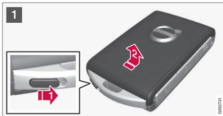
1 **1** Halten Sie den Transponderschlüssel so, dass die Vorderseite nach oben weist und das Volvo-Logo richtig ausgerichtet liegt. Schieben Sie den Schalter beim Schlüsselring am unteren Rand nach rechts. Drücken Sie die vordere Abdeckung einige Millimeter nach oben.
