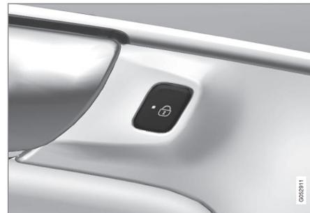
Verriegelungstaste mit Anzeigeleuchte an der Hintertür.
