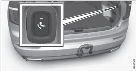
1. Öffnen Sie die Heckklappe. An der rechten Kofferraumwand befindet sich ein Schalter zum Ein- und Ausklappen der Anhängerkupplung. Damit die Anhängerkupplung ausgeklappt werden kann, muss die Anzeileuchte des Schalters orange leuchten.
