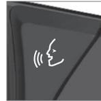
Der Fahrer kann das Sprachsteuerungssystem verwenden, ohne die Hände vom Lenkrad zu nehmen. Das System versteht natürlich gesprochene Sprache. Verwenden Sie die Sprachsteuerung, um einen
