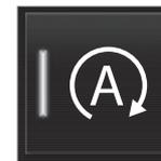
Die Deaktivierung erfolgt über die Funktionstaste **Start/Stop** in der Ansicht Funktionen auf dem Center Display. Bei deaktivierter Funktion ist die Tastenanzeige ausgeschaltet.
