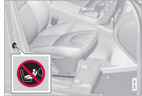
2. variant: kaassõitja turvapadja silt uksepiilaril. Turvapadja silt on nähtav juhi kõrvalistuja ukse avamisel.
