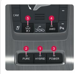
Для привода автомобиля используются два двигателя – электрический и дизельный. Вы можете выбрать различные режимы привода. Вы не можете выбрать "неправильный" режим привода – при несоблюдении определенных условий автомобиль возвращается в режим HYBRID. В этом случае включается лампа в кнопке HYBRID.
