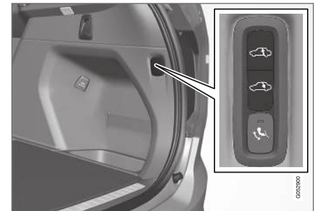
Commandes de levage/abaissement de l'arrière du véhicule.
