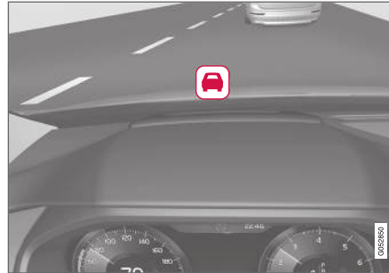
Pictogramme d'avertissement de collision sur le pare-brise 64 .
