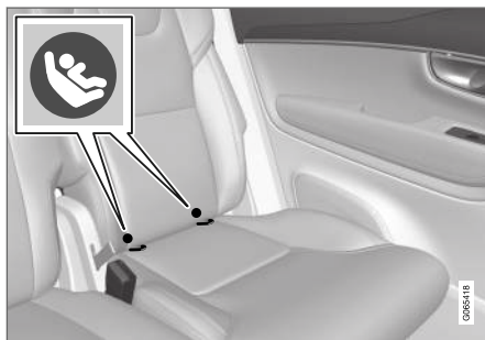
Emplacement des ancrages ISOFIX/LATCH
