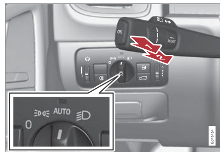
สวิตช์โยกและปุ่มสำหรับควบคุมไฟหน้า
