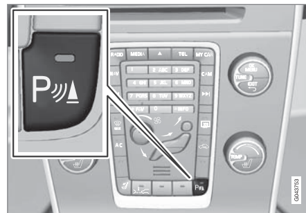
เปิด/ปิด สำหรับระบบช่วยขณะจอด
