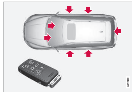
Låspunkter för fjärrnyckel med nyckelblad.
