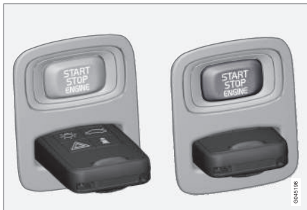
Startlås med fjärrnyckel utdragen/intryckt och START/STOP ENGINE-knapp .
