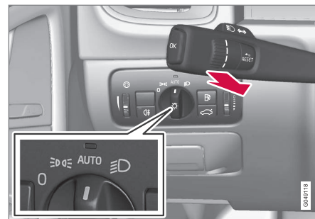
Rattspak och ljusreglagets vred i läge AUTO .
