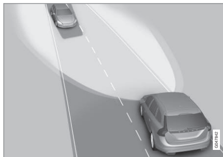
Adaptiv funktionalitet: Halvljus direkt mot mötande fordon, men fortsatt helljus på båda sidor om fordonet.
