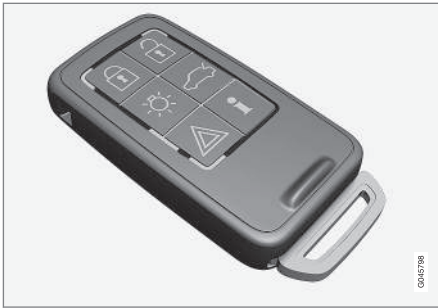
Kluczyk z pilotem zdalnego sterowania z funkcją PCC* (Personal Car Communicator).
