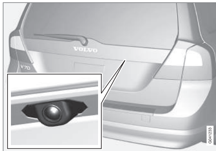
Cameraspositie bij de openingshandgreep.
