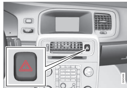
Кнопка аварійної сигналізації.
