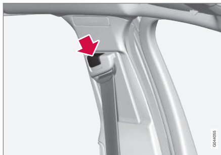
Регулювання висоти ременя безпеки. Натисніть кнопку та відрегулюйте верхнє кріплення у вертикальній площині. Розташуйте верхнє кріплення якомога вище, але щоб при цьому ремінь не терся вам по шиї.
