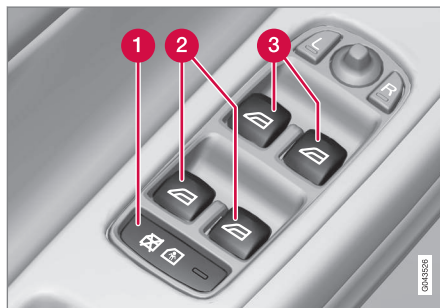
A vezetőajtó vezérlőpanelje.
