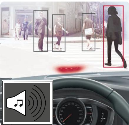
Установленная в автомобиле система предупреждения о столкновении с автоматическим торможением и обнаружением велосипедистов и пешеходов может предупредить, затормозить и/или остановить автомобиль, чтобы предотвратить столкновение с транспортным средством, велосипедистом или пешеходом.
