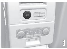
Toma de 12 V en la consola del túnel, asiento trasero.
