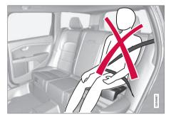
Colocación incorrecta, la cabeza no debe salir por encima del reposacabezas y el cinturón no debe ir por debajo del hombro.
