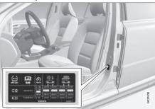
La placa de presión de neumáticos situada en el montante de la puerta del lado del conductor (entre la puerta delantera y la trasera) especifica la presión que deben tener los neumáticos en diferentes condiciones de carga y velocidad. Estos datos se indican también en la tabla de presiones de neumáticos, véase Neumáticos - presiones de inflado aprobadas (p. 438).
