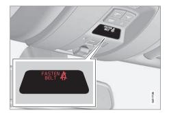
El aviso acústico depende de la velocidad y, en algunos casos, del tiempo. La señal luminosa se puede ver en la consola del techo y en el cuadro de instrumentos (p. 69).
