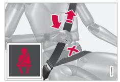
Estire la banda de la cintura tirando de la banda diagonal arriba hacia el hombro. La banda de la cintura debe ir baja (no por encima del abdomen).
