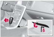
Si el automóvil no está en condiciones para conducirse, por ejemplo, si la batería de arranque está descargada, el selector de marchas debe sacarse de la posición **P**, para poder mover el vehículo.
