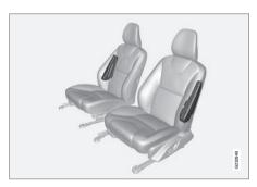
El sistema SIPS-bag consta de dos componentes principales, airbag lateral y sensores. El airbag lateral va colocado en el bastidor del respaldo del asiento delantero.
