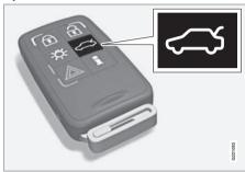
El botón del mando a distancia permite desbloquear el portón trasero y desconectar la alarma\* correspondiente.
