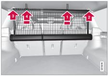
La red se extrae de los chasis y se bloquea automáticamente después de aproximadamente un minuto si el respaldo del asiento trasero está levantado.
