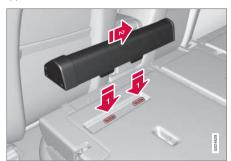
El chasis de dos piezas se fija en la parte trasera del respaldo. El chasis más delgado se fija en el lado izquierdo (visto desde el portón trasero).
