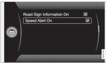
El conductor puede optar por recibir una advertencia en caso de rebasar el límite de velocidad vigente en 5 km/h (5 mph) o más. La advertencia se presenta a través del parpadeo temporal del símbolo con el límite de velocidad aplicable al superarse ésta. El sistema puede conectarse v desconectarse en el sistema de menús MY CAR. Para una descripción del sistema de menús, véase MY CAR (p. 125).
