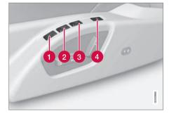
La función de memoria guarda los ajustes del asiento y de los retrovisores exteriores.
