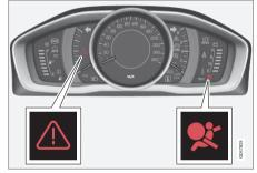
Triángulo de advertencia y símbolo de advertencia del sistema de airbags (p. 35) en el cuadro de instrumentos analógico.
