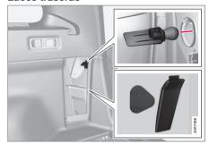
La bombilla del intermitente trasero se cambia dentro del compartimento de carga.
