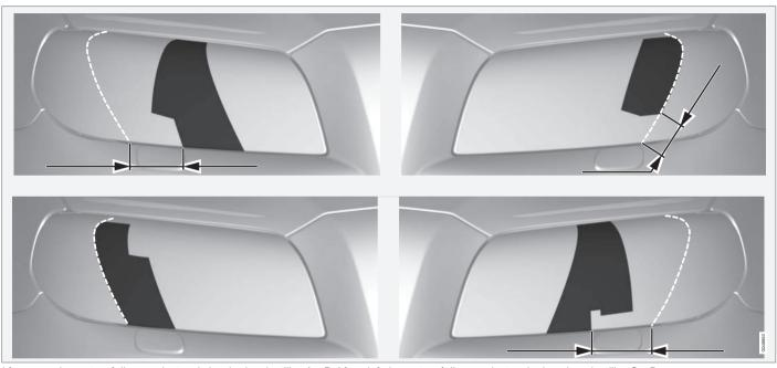
Línea superior: automóvil con volante a la izquierda, plantillas A y B. Línea inferior: automóvil con volante a la derecha, plantillas C y D.
