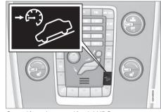
Conexión y desconexión del HDC
