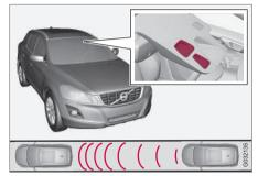
Ventanas del emisor y el receptor del sensor láser<sup>13</sup>.
