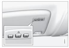
HomeLink<sup>©27</sup> es un mando a distancia programable que puede controlar hasta tres dispositivos diferentes (por ejemplo, la puerta del garaje, el sistema de alarma, la iluminación exterior e interior, etc.) y utilizarse por tanto en lugar de los mandos a distancia correspondientes.
