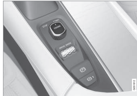
De startknop op de tunnelconsole.
