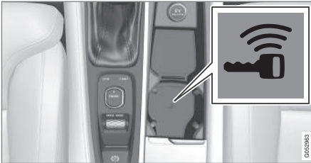
Positie back-uplezer in tunnelconsole.
