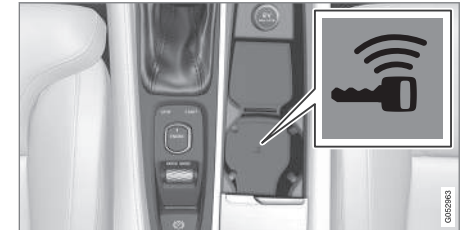
Positie back-uplezer in de tunnelconsole.
