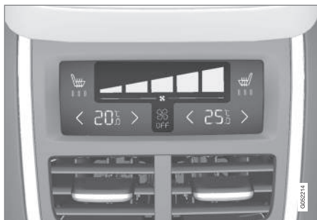
Ventilatorregeling op klimaatpaneel achter op tunnelconsole.
