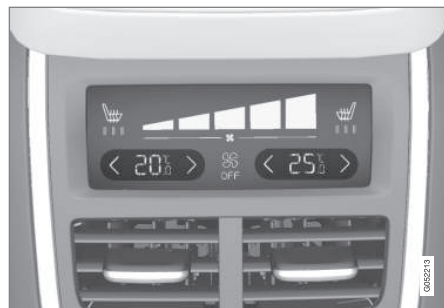
Temperatuurregeling op klimaatpaneel achter op tunnelconsole.
