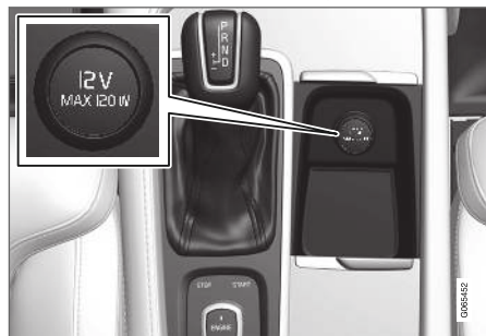
12V-aansluiting in tunnelconsole, voorin.
