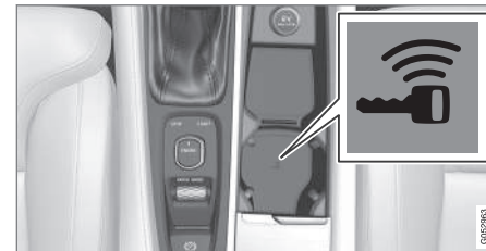
Umístění záložní čtečky v tunelové konzole.
